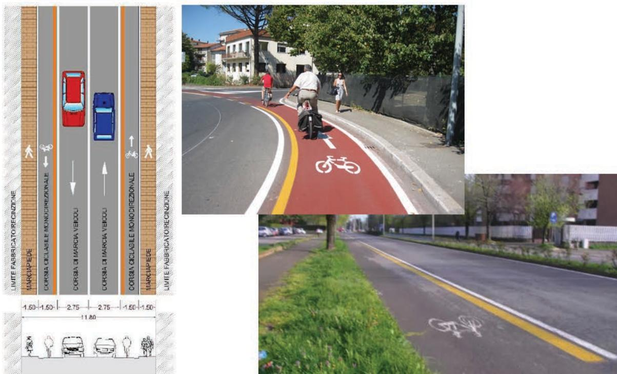
Figura 63 - Tipologia di pista in sede separata
