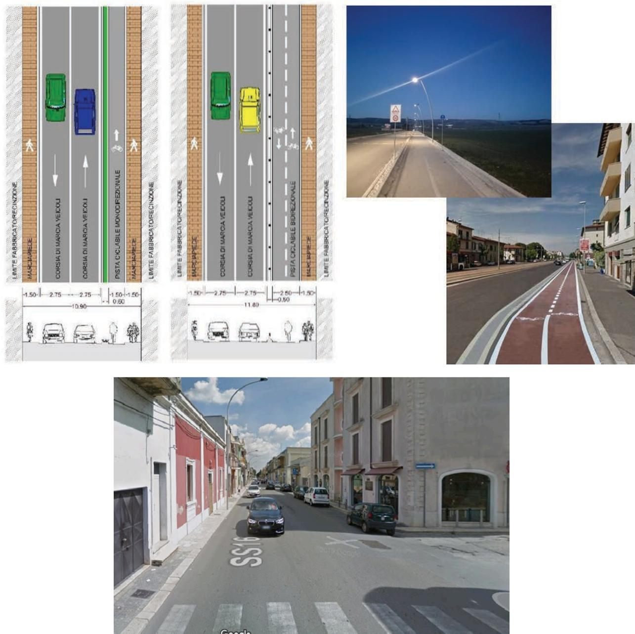
Figura 62 - Tipologia di pista in sede propria
